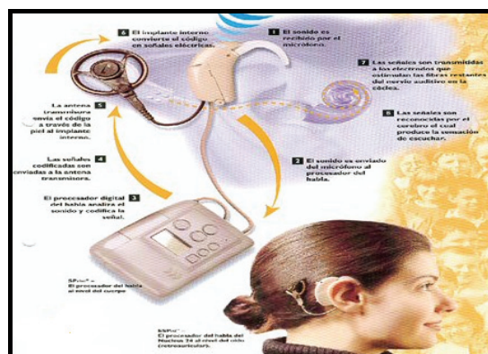
Fig. 1 Esquema de un Implante Coclear ( http://www.cochlear.org )
